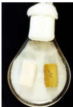
Prüfanordnung für die Bestimmung der Wirksamkeit von Holzschutzmitteln nach EN 113
