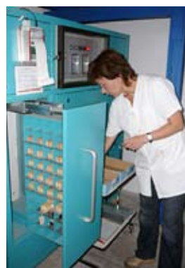
Windkanal für die Verdunstungsbeanspruchung
