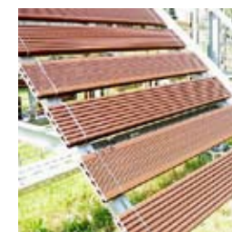
Prüfung von WPC auf Freibewitterungsstand
